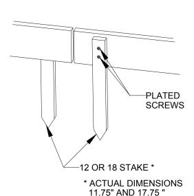
3b USE A STEEL"J" STAKE LEAVING A GAP FOR THERMAL EXPANSION
